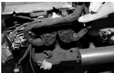
長田さんの転倒のきっかけであり、そしてその後リコールの対象となった問題のボルテージレギュレーター（写真中心）。
